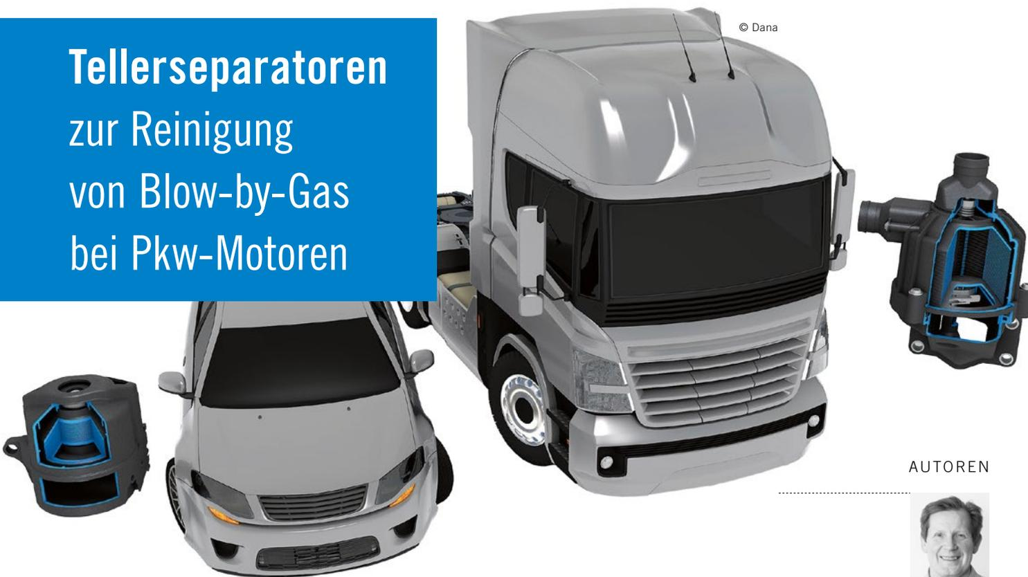
Die Grenzwerte für die Reinigung des Blow-by-Gases werden strenger, Ölpartikel immer kleiner. Reinz aus Neu-Ulm, ein Tochterunternehmen des US-amerikanischen Unternehmens Dana, hat deswegen gemeinsam mit 3nine einen Tellerseparator für Verbrennungsmotoren entwickelt, der speziell unter 0,6 µm kleine Ölpartikel effizient aus dem Blow-by-Gas abscheidet, und das zu nahezu 100 %.
